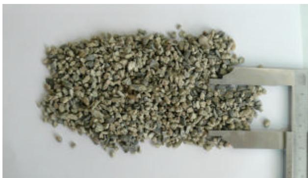
Figura: 3.2: Agregado reciclado 3, retenido en el tamiz 4,75 mm.
