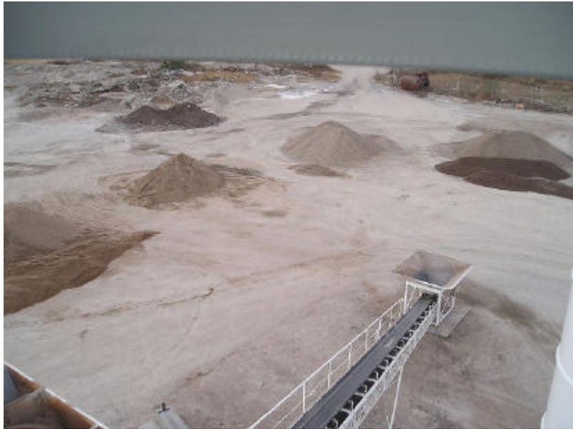
Figura 1.1: Desechos de hormigón en planta de hormigón elaborado.
