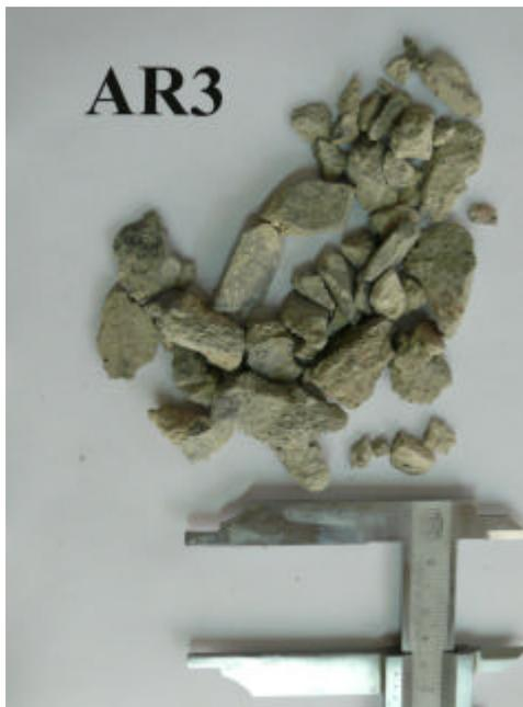
Foto: 3.1: Agregado reciclado 3 sin tamizar.
