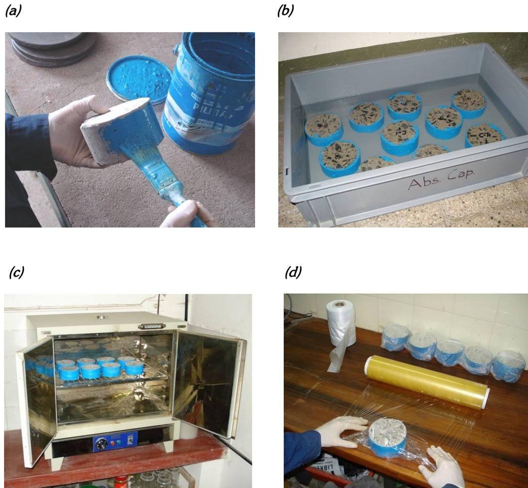
**Figura 5.3:** Pre-acondicionamiento de las muestras *(a)* impermeabilización, *(b)* saturación, *(c)* secado y *(d)* embalaje.
