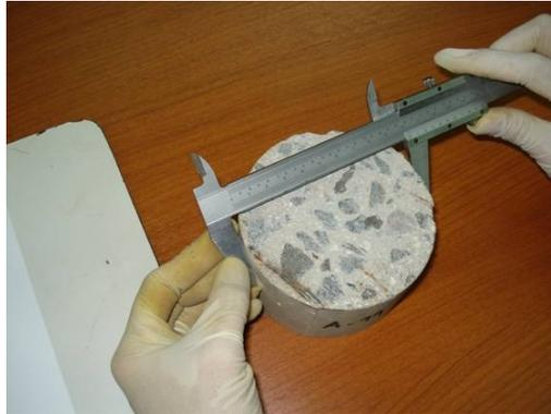
**Figura 5.2:** Medición del diámetro de las muestras de ensayo.
