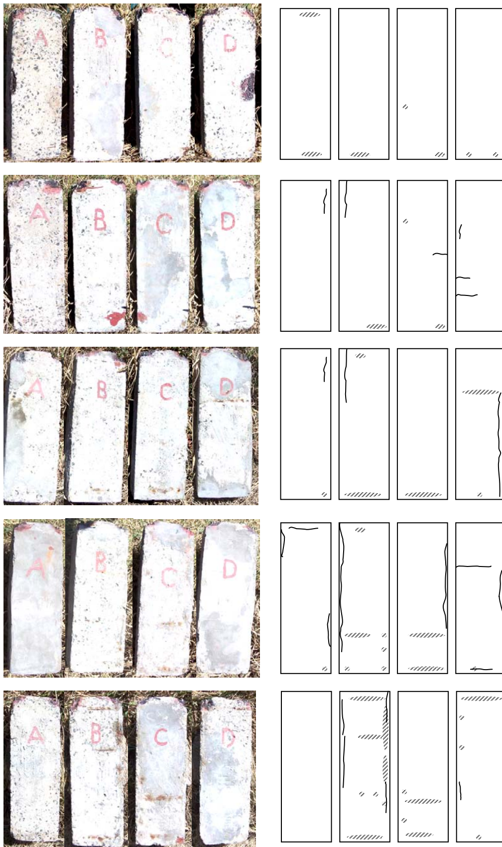
Figura 5.54. Patrones de fisuración y de manchas por corrosión.
