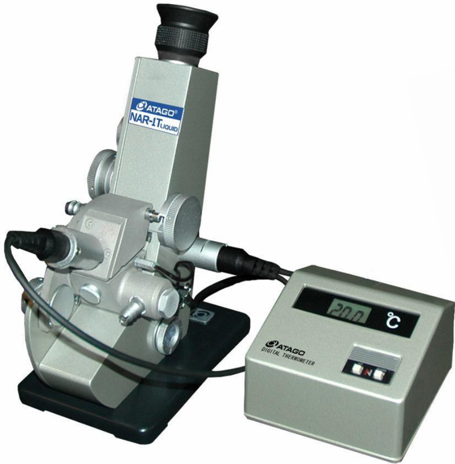
Refractómetro de Abbe con sistema de control de T
