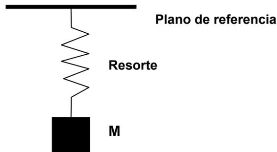
Fig. 1.6 — Sistema resonante mecánico.
