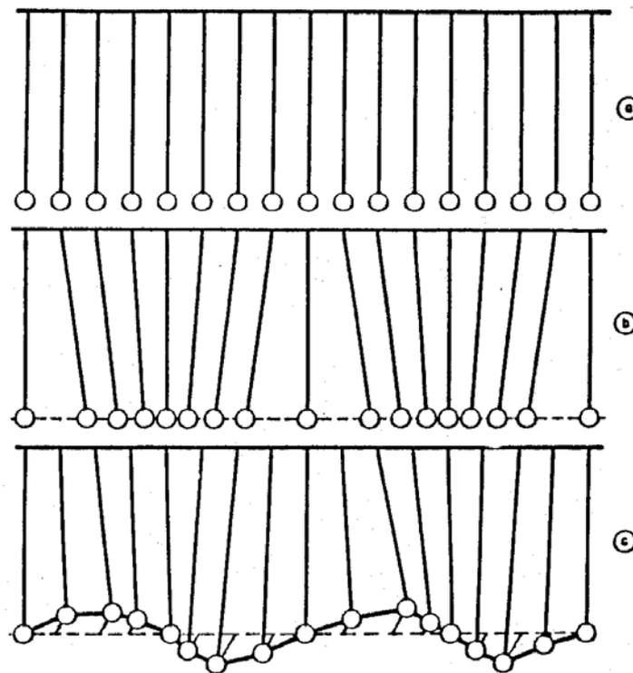
Fig. 1.2 - Propagación de ondas. (a) Péndulos en reposo; (b) Propagación longitudinal; (c) Propagación transversal.
