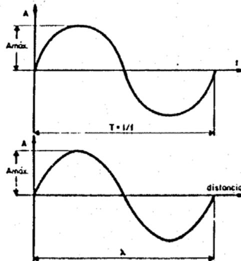
Fig. 1.1 - Oscilación senoidal. (a) Variación en función del tiempo. (b) Variación en función de la distancia.
