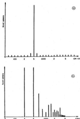
Fig. 1.3 — Espectros discontinuos. (a) Espectro del sonido de 400 Hz de órgano; (b) Espectro del sonido de 216 Hz de violonchelo.
